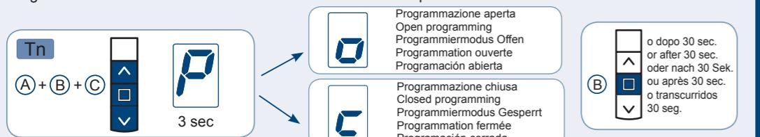
PIER MODIFICARE LO STATO DELLA FUNZIONE VEDI LE SEQUENZE ABILITAZIONE/DISABILITAZIONE - To change the status of the function, see the sequences "enable/disable programming" - Zur Änderung des Programmiermodus, "Öffnen/Sperren" wie hier folgend geschildert vorgehen - Pour modifier l'état de la fonction voir les séquences activation/désactivation - Para modificar el estado de la función ver las secuencias habilitar/deshabilitar
