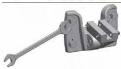
Fase 9. Mettere i supporti parete EOS e i supporti a pavimento. I supporti parete devono rimanere orizzontali mentre i supporti a pavimento paralleli alla parete. Vedere posizione dei fori nella figura allegata.
