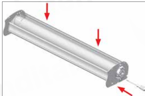
Fase 5. Mettere il rullo+tessuto+motore+supporto motore nel profilo inferiore e avvitarlo.
